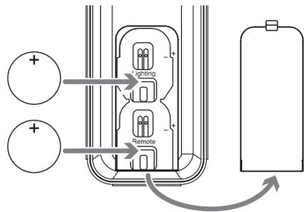
Retire la tapa del compartimiento de las baterías, inserte las baterías tipo botón suministradas y empuje cada una para que quede por debajo del resalte en el compartimiento con el símbolo "+" marcado. Vuelva a colocar la tapa.
